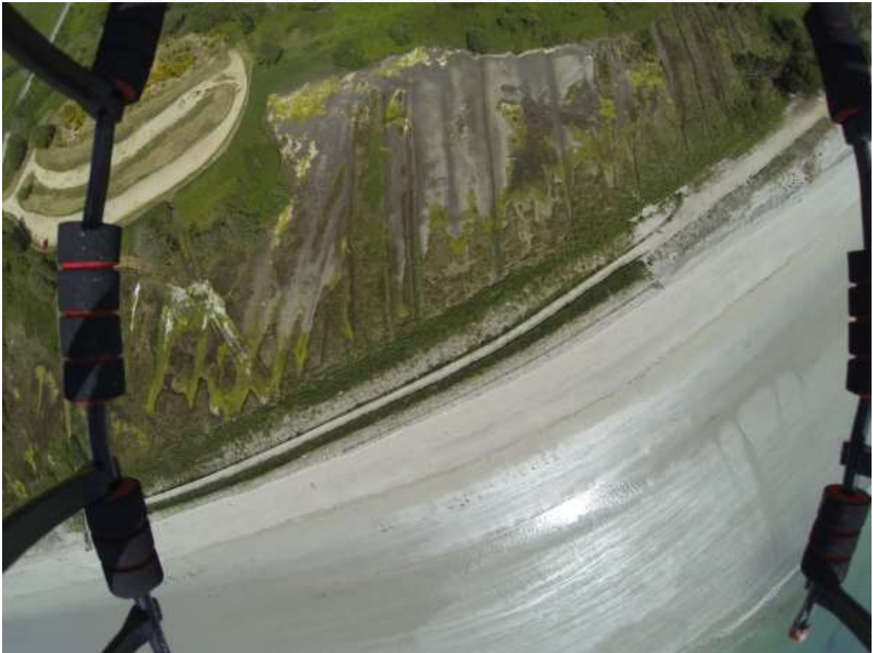
Figure 27 : Le drone "Wallee" en train de prendre des photos azimutales du trait de côte afin de pouvoir post géoréférencement en dessiner la limite (photo B. Guillot 145m mai 2014)
