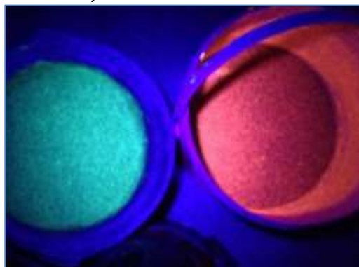
Figure 24 : Aperçu de la réaction du sable peint en fluorescent avec la lampe à LEDs violettes
